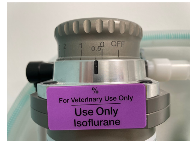
Photo 9 – test de fuites sur cuve – maintenir un faible % d'iso durant le test
