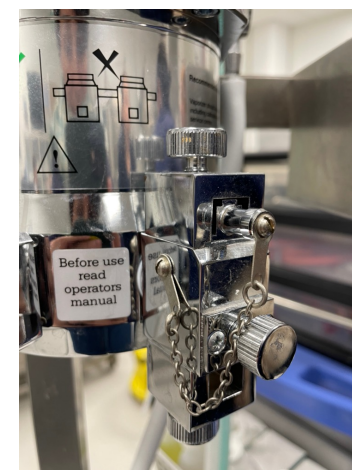
Photo 8 – Le site de remplissage est une zone de fuite majeure
