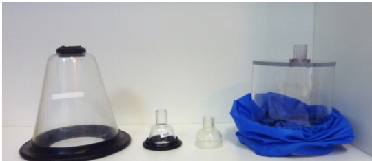
Photo 12 & 12bis – Différents modèles de masque existent et permettent de s'adapter au plus près du faciès de l'animal, limitant ainsi les fuites
